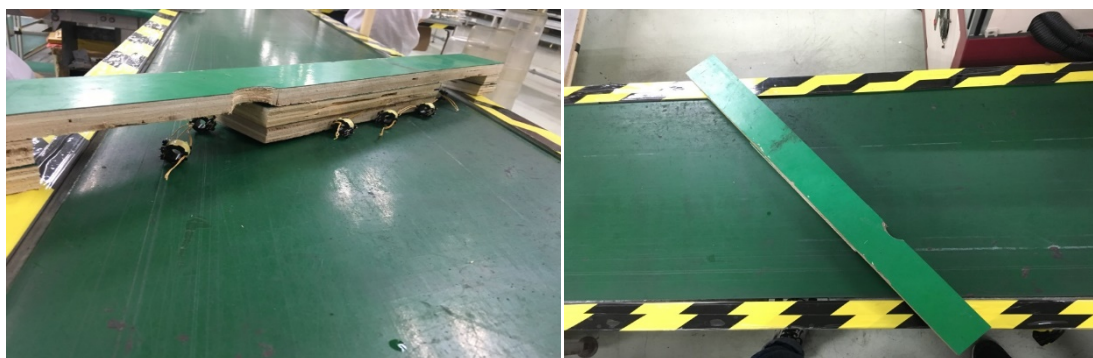
圖三、 ECRS 改善 Simplify - 工治具製作(引流板)
